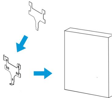
2. Placer l'appareil sur le support de montage, puis fixer le bas de l'appareil sur le support à l'aide de la vis antivol.
