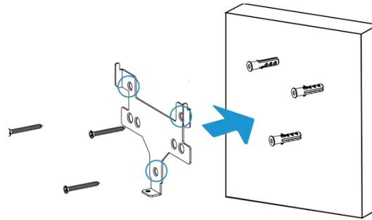
2. Placer l'appareil sur le support de montage, puis fixer le bas de l'appareil au support à l'aide d'une vis de fixation.
