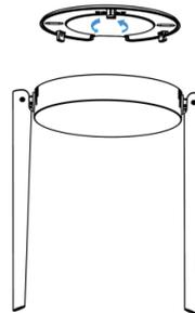
Alignez horizontalement la plaque de fixation à l'emplacement souhaité sur le mur ou le plafond, marquez deux trous de fixation, percez ces trous aux emplacements marqués, et insérez des chevilles murales dans les trous.
